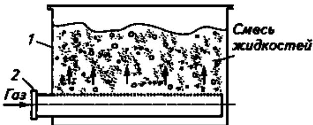
Рис. 8.3. Схема пневматического смесителя (барботера): 1 – корпус; 2 – барботер
